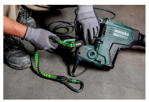
La dragonne se noue simplement autour de l'outil électrique, le mousqueton s'attache à un point de fixation. **Photo : Metabo**
