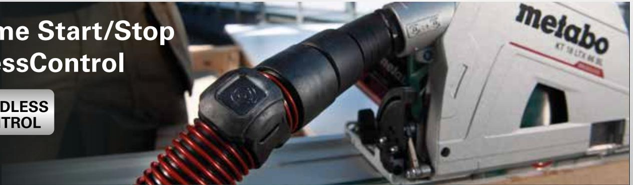
Aspiration avec mise en marche/arrêt automatique pour les aspirateurs filaires utilisés avec une machine sans fil grâce à la détection des vibrations
